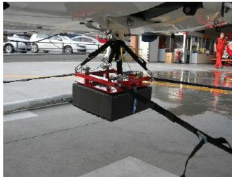
Système GPR-Hél (antenne 400 MHz)
